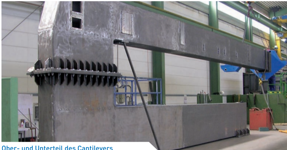
Ober- und Unterteil des Cantilevers Der gesamte Cantilever wiegt bis zu 60 Tonnen und ist bis zu 18 Meter lang
